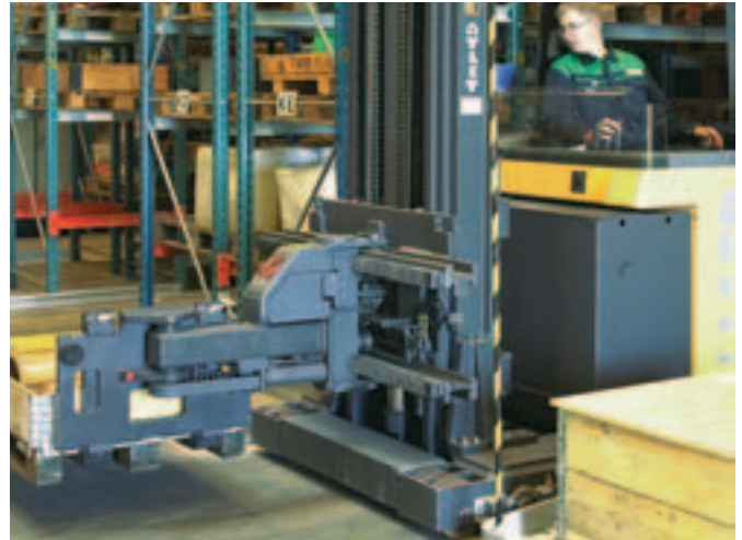
Automatischer Stopp bedeutet Sicherheit. Durch die eingebaute Gangendabremmung stoppt das Fahrzeug automatisch am Gangende. Das Fahrzeug stoppt auch bei Hindernissen im Gang, wie z.B. einer Person (Personenschutzanlage).
