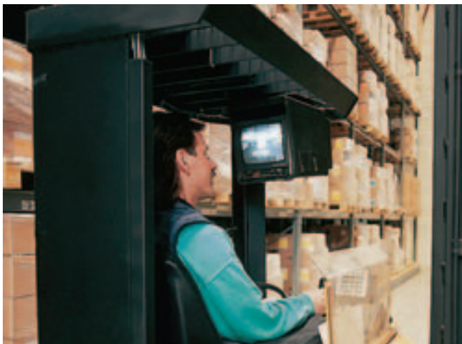
Mit einer Videoausstattung mit einer oder mehreren Kameras hat der Fahrer die jeweilige Palette immer im Blick.
