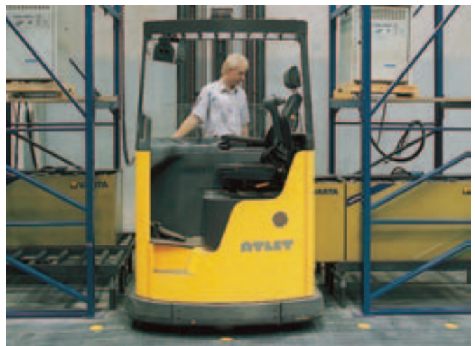
Für den Mehrschichtbetrieb steht ein elektrisches Batteriewechselsystem zur Verfügung.
