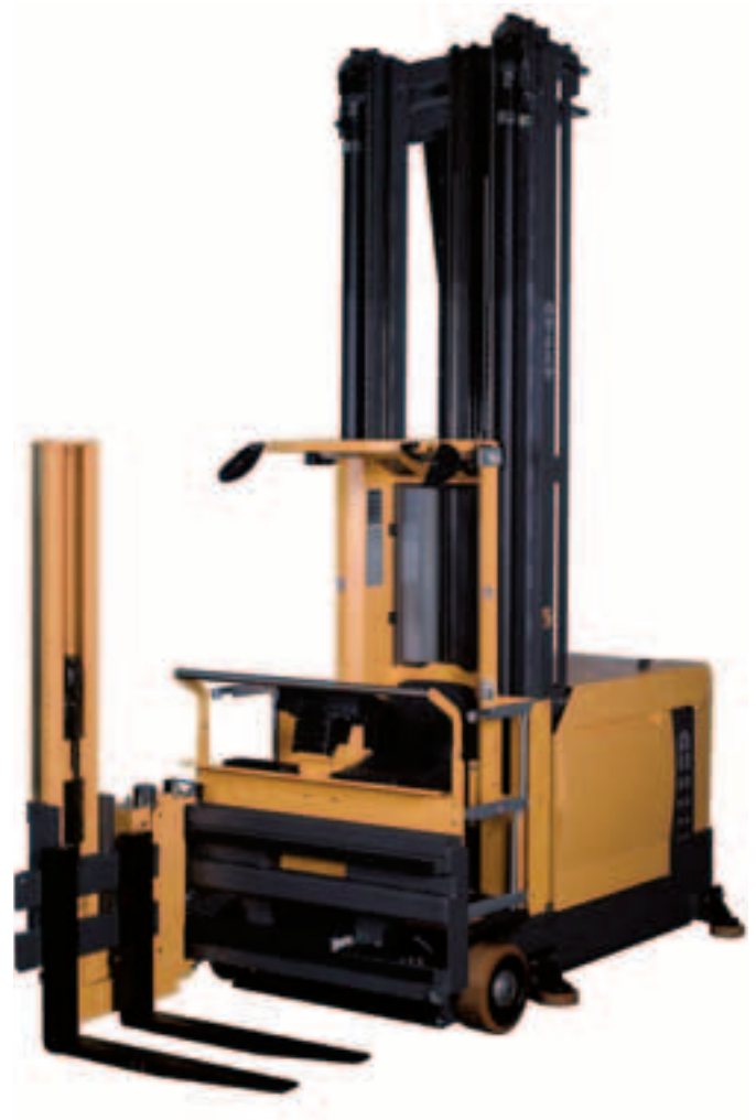
DCR 120 Stapeln bis 9.790 mm Kommissionieren bis 10.250 mm
