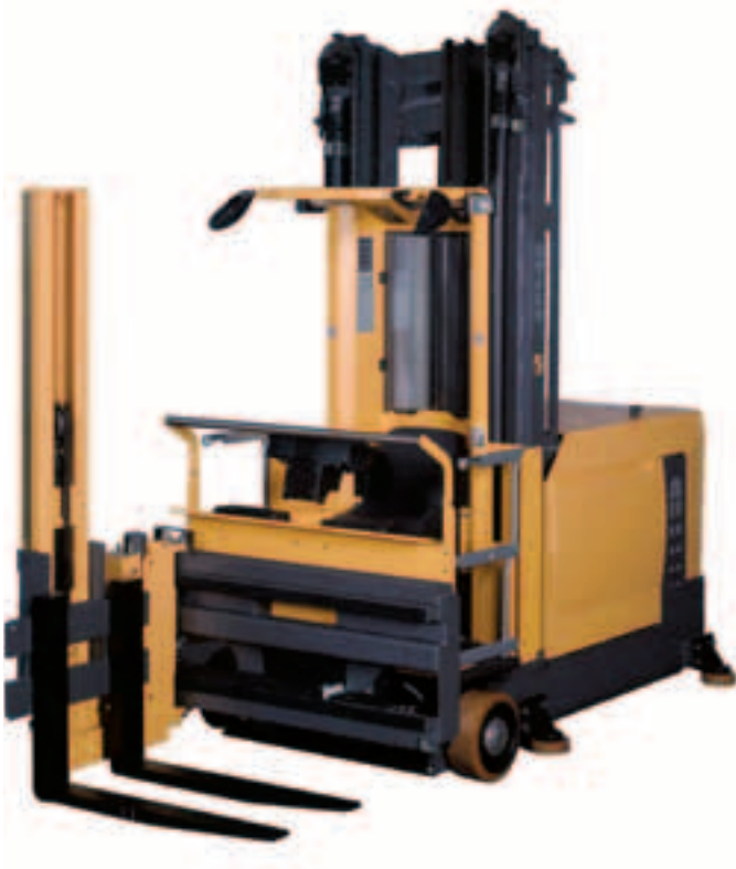
DCR 100 Stapeln bis 7.500 mm Kommissionieren bis 7.800 mm
